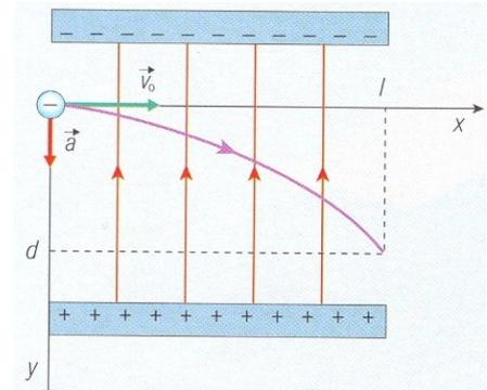
Per lo studio del moto fissiamo il sistema cartesiano rappresentato in figura, con l'asse  $x$  diretto come la velocità iniziale  $v_0$  e l'asse  $y$  diretto in verso opposto al campo elettrico  $\mathbf{E}$  esistente fra le placche, cioè orientato come l'accelerazione  $\mathbf{a}$ :
