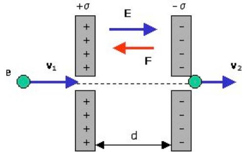
3. Se al posto dell'elettrone poniamo un protone, in base alla legge (1), avremo che la particella, essendo carica positivamente, subirà una decelerazione se entrerà dalla parte della superficie carica negativamente (vedi figura), e una accelerazione se entrerà dalla parte della superficie carica positivamente (vedi figura).
